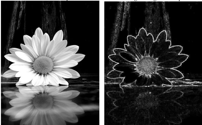
Figura 4: Resultado da aplicação do filtro Sobel para detecção de bordas utilizando o sistema implementado em FPGA . Imagem original à esquerda.
