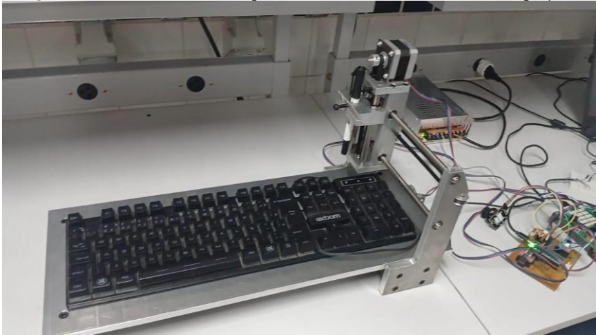
Figura 2: Estrutura mecânica e placas de microcontrolador finais do projeto.
