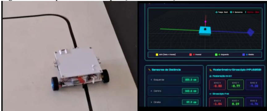
Figura 2: Protótipo do AGV em operação e visualização do sistema no dashboard
