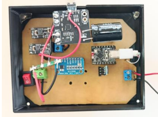
Figura 2: Protótipo físico da Fonte Inteligente de Backup
